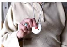
**Le principe de la téléalarme est simple :** un seul appui sur le bouton d'alerte situé soit sur un collier soit sur un bracelet à porter sur soi ou encore sur l'appareil central et aussitôt une alerte est transmise au centre d'écoute ouvert 24h/24.
