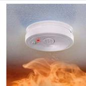
L'installation d'un détecteur de fumée doit permettre de détecter les fumées émises dès le début de l'incendie et d'émettre immédiatement un signal sonore suffisant pour permettre de réveiller une personne endormie (il existe des détecteurs spécialement adaptés aux personnes sourdes fonctionnant grâce à un signal lumineux ou vibrant). Il doit être fixé le plus haut possible dans un lieu de circulation ou dans le dégagement desservant les chambres et à distance des murs et des sources de vapeur.
